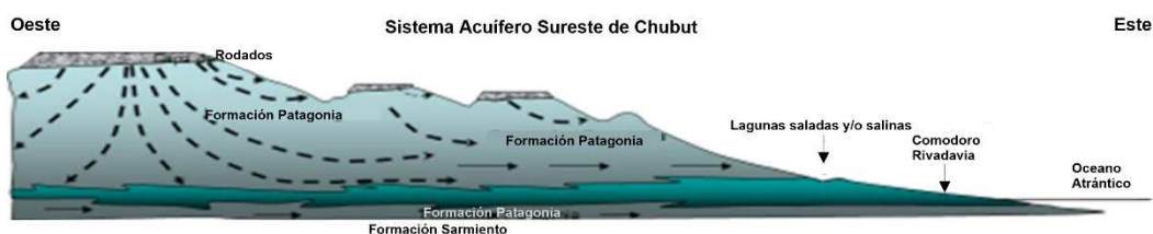
Figura 5. Perfil esquemático del Sistema Multiunitario. Modificado de Castrillo et al. (1984).
